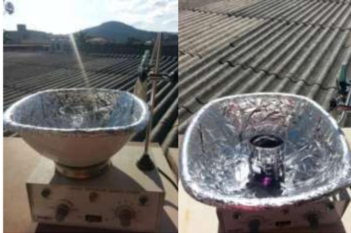
Imagem 04: Imagens do reator solar utilizado nos testes fotocatalíticos.
