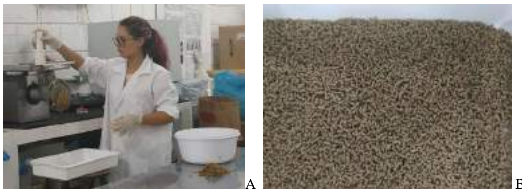
Figura 3 – Processo de peletização da ração em A, e em B ração pronta com 2 mm de espessura.
